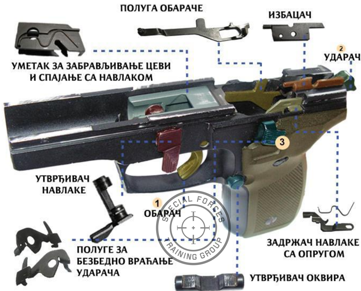
Слика12. - Делови механизма за запињање и окидање
