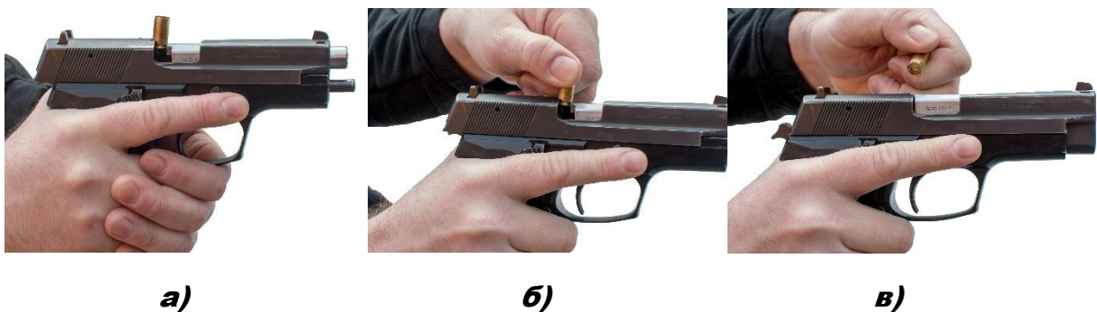
Слика 24. - Отклањање застоја узрокованог чауrom
