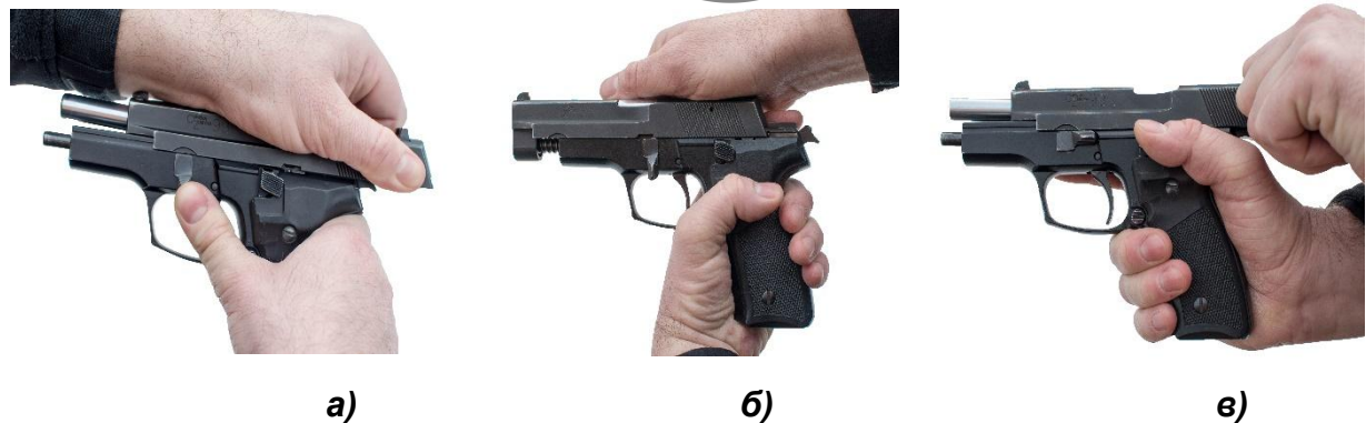
Слика 3. - Одвајање навлаке
