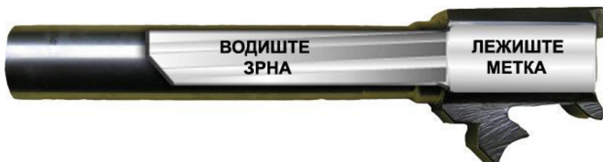
Слика 7. - Попречни пресек цеви
